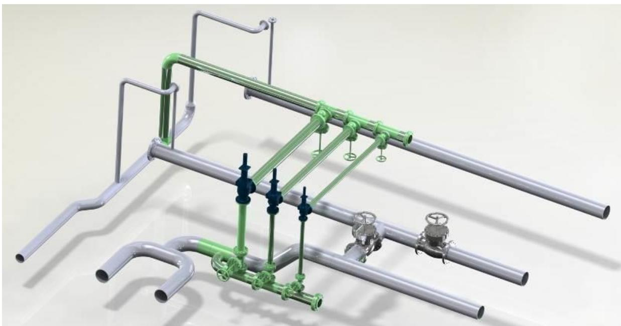
**Figura 36. Projeto do sistema de testes de PRV's montado na área dos scrapers no Oleoduto de Teste (SolidWorks,2013)**
