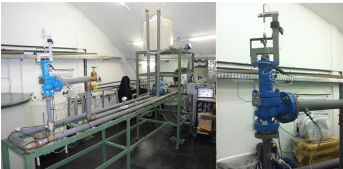
Figura 32 - Fotografia da bancada experimental e detalhe da PRV instrumentada [2]
